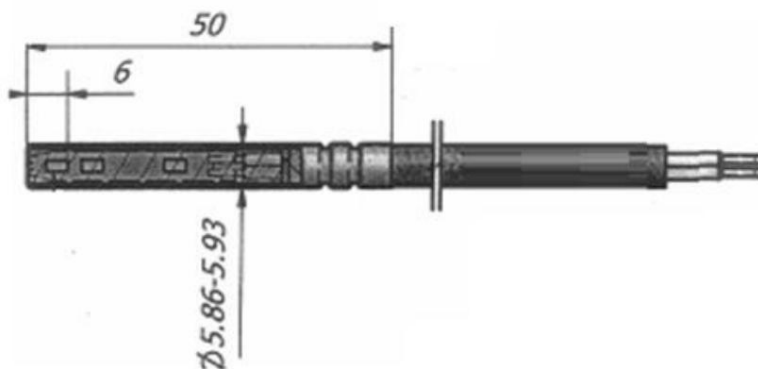
Fig. B3.2 Overordnede dimensjoner for PL-type temperaturløser
